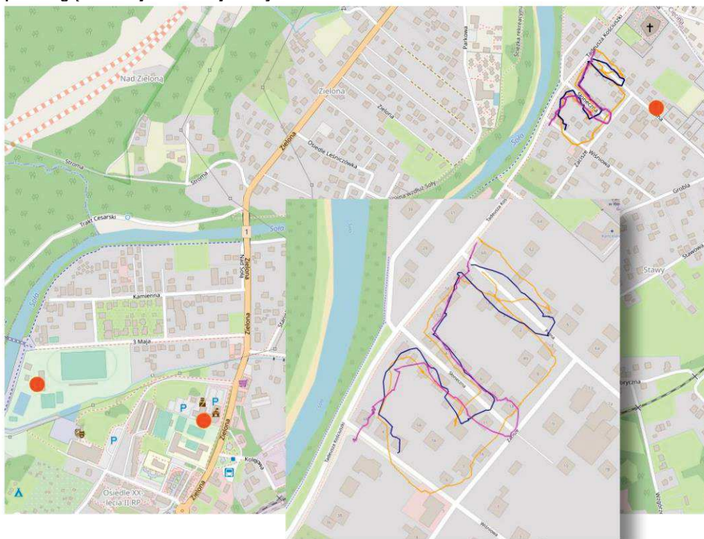
Rysunek 9. Trasa przelotów dronem nad hot-spotem w Węgierskiej Górze oraz lokalizacja hot-spotu względem czujników stacjonarnych
