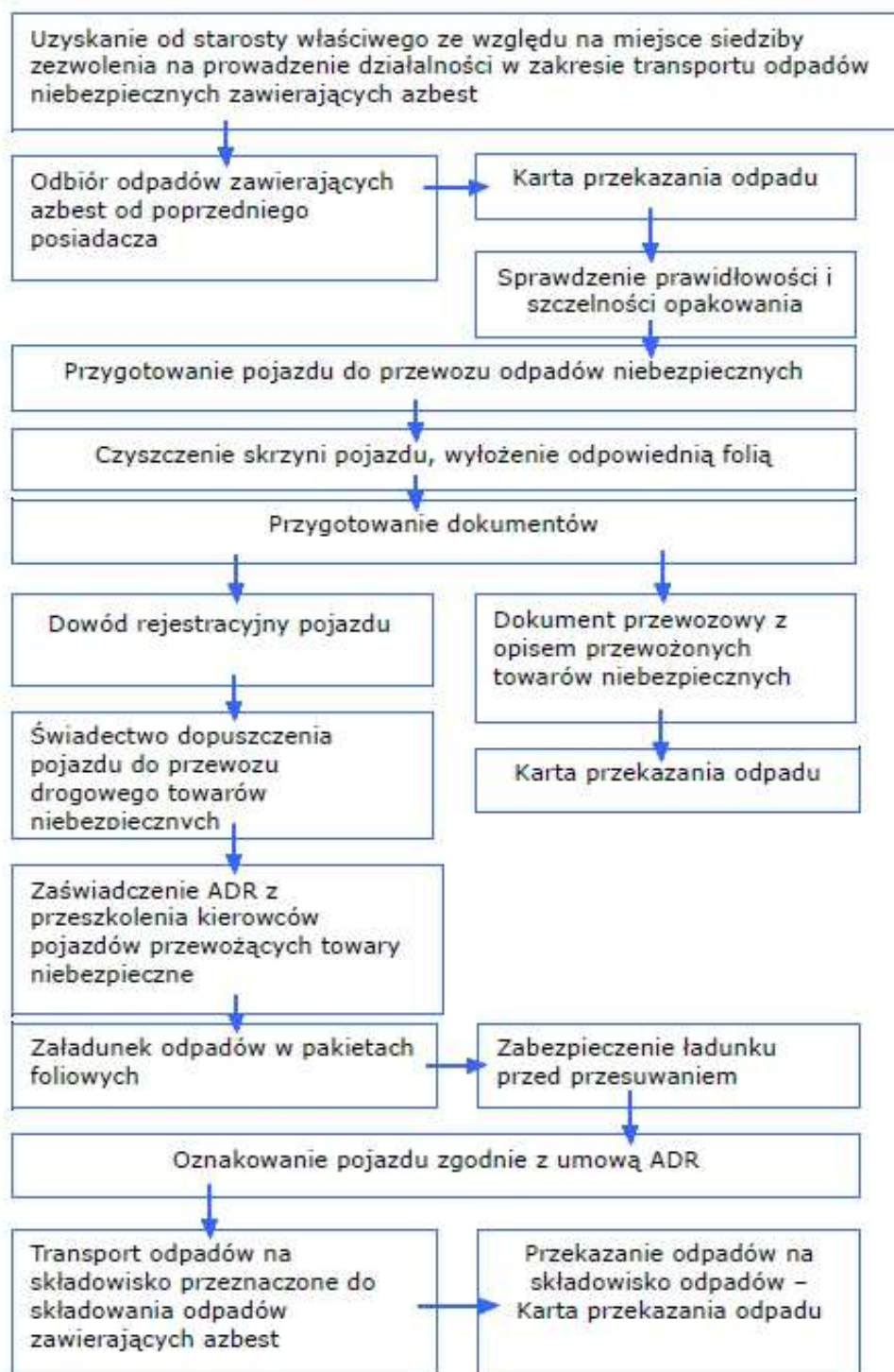
Rysunek 9. Schemat procedury dotyczącej przygotowania i transportu odpadów niebezpiecznych zawierających azbest.
